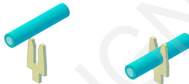
\* 電線の絶縁被膜は取り除かずに、コンタクトの精密なスリットにそのまま挿入、スリットは被膜を突き破り導体を変形しガストライ接続をする方法。
